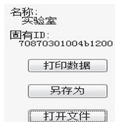
a. 打印数据： 分页打印所有历史数据，分为曲线打印和文本数据打印两种；默认 A4 纸张，打印时可重新设置纸张大小。
